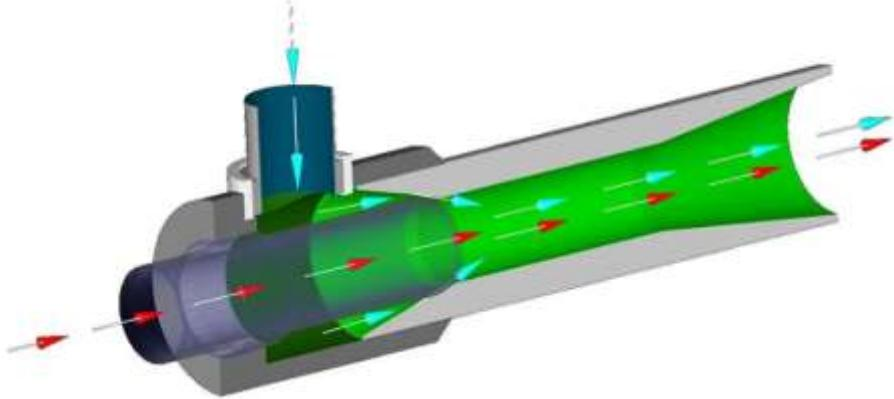
Принцип действия эжекторов основан на законе Бернулли. При увеличении скорости движения потока, вокруг него образуется область разряжения. Поток проходит через сопло. Диаметр сопла меньше диаметра остальной конструкции. Из-за сужения сопла, поток значительно ускоряется, после чего попадая в камеру смесителя, создаёт пониженное давление. Происходит смешение сред, и передача кинетической энергии от среды движущейся с большей скоростью, к среде с более низким потенциалом.
